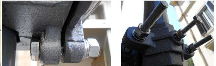
Fixez la plaque de montage entre la flèche et le mât **PIA40JXX** entre les éléments **3 - 4**
